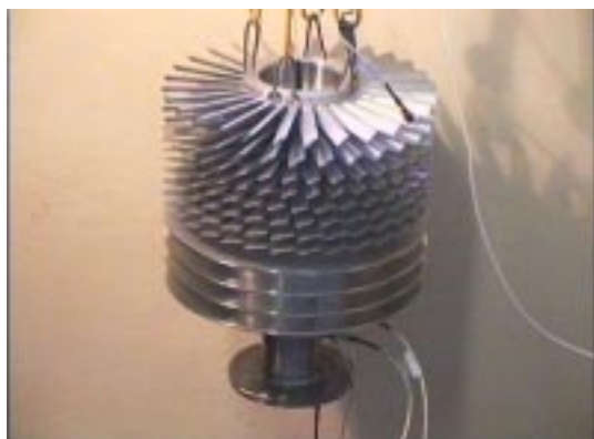
Rotore di pompa turbomolecolare su sospensione magnetica.
